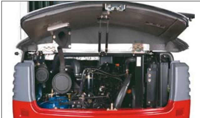
Abgas- und lärmreduzierte Motorengeneration, geräumiger Motorraum, Auspuffaustlass nach oben; massives Gegengewicht
