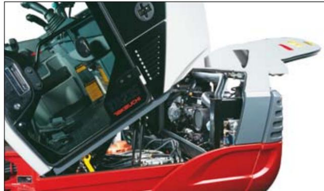
Kippbare Kabine mit servicefreundlichem Zugang zum Motor und den Hydraulikaggregaten
