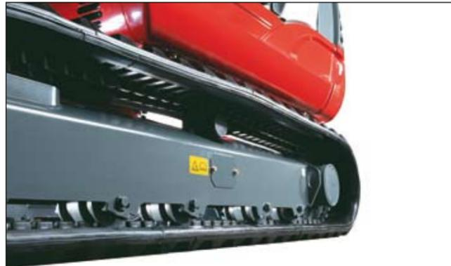
Laufrollen mit Innen- und Aussenführung für sicheren Gummikettenlauf und Double-Short-Pitch Gummiketten für vibrationsarmes Fahren
